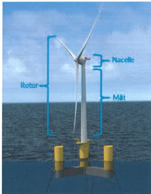
Figure 4: Eléments de l'éolienne (source : EOLFI à partir de GE et Naval Energies)
