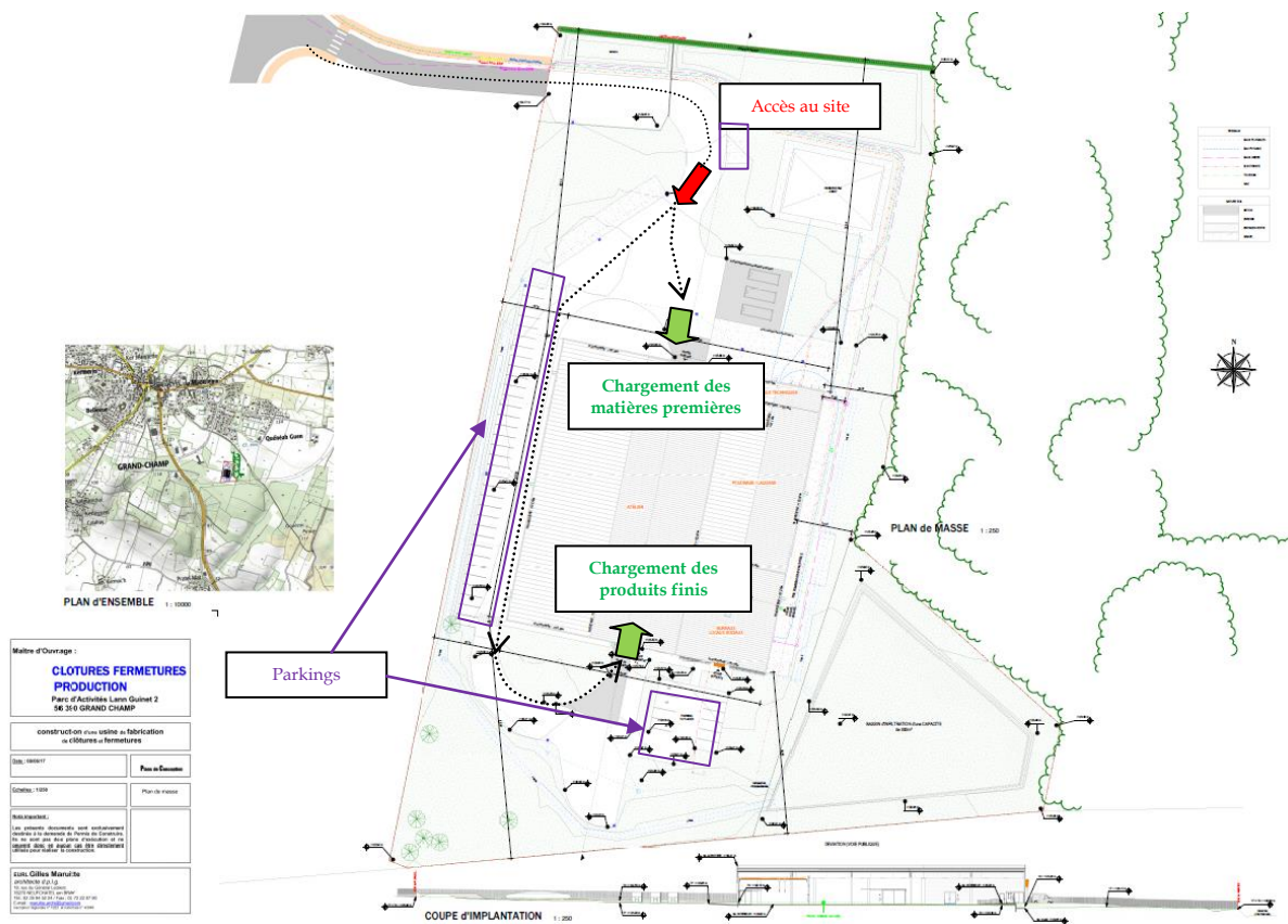
Figure 7 : Accès aux services de secours
