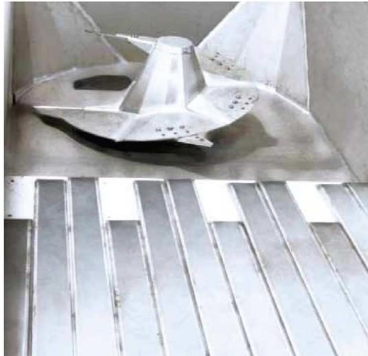
**Photo 3 : Barres de poussée Big-Mix avec zone de mélange**
