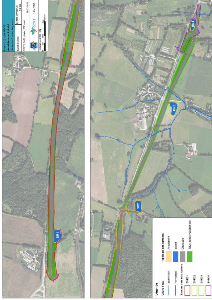
Figure 100- Exemple d'un bassin multifonction réalisé à Colpo – RD 767 (source : CD 56)
