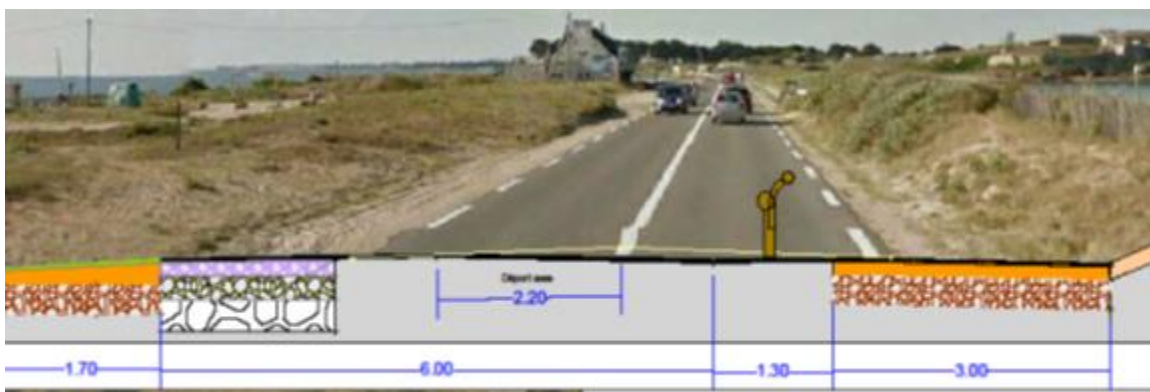
Figure 4 : Coupe de principe de l'aménagement de l'agglomération de Penthièvre à l'ancienne maison du garde barrière
