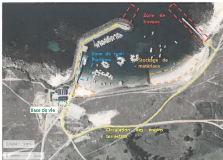
Figure 7: Plan de circulation du chantier
