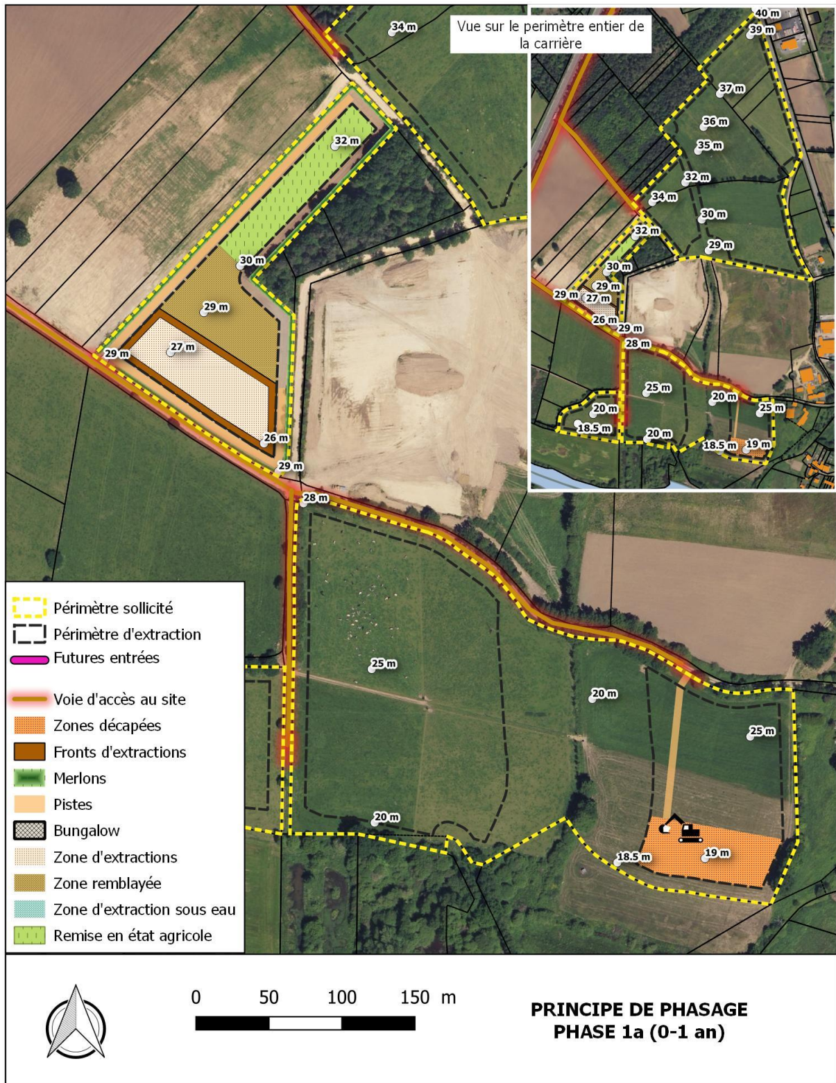
Fig. 17 : Principe de phasage – Phase 1a (0-1 an)
