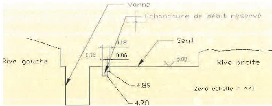
Le seuil à une hauteur de 76 cm environ, atténué pour le franchissement piscicole par un pré-barrage en enrochements et l'échancrure dans le seuil.
