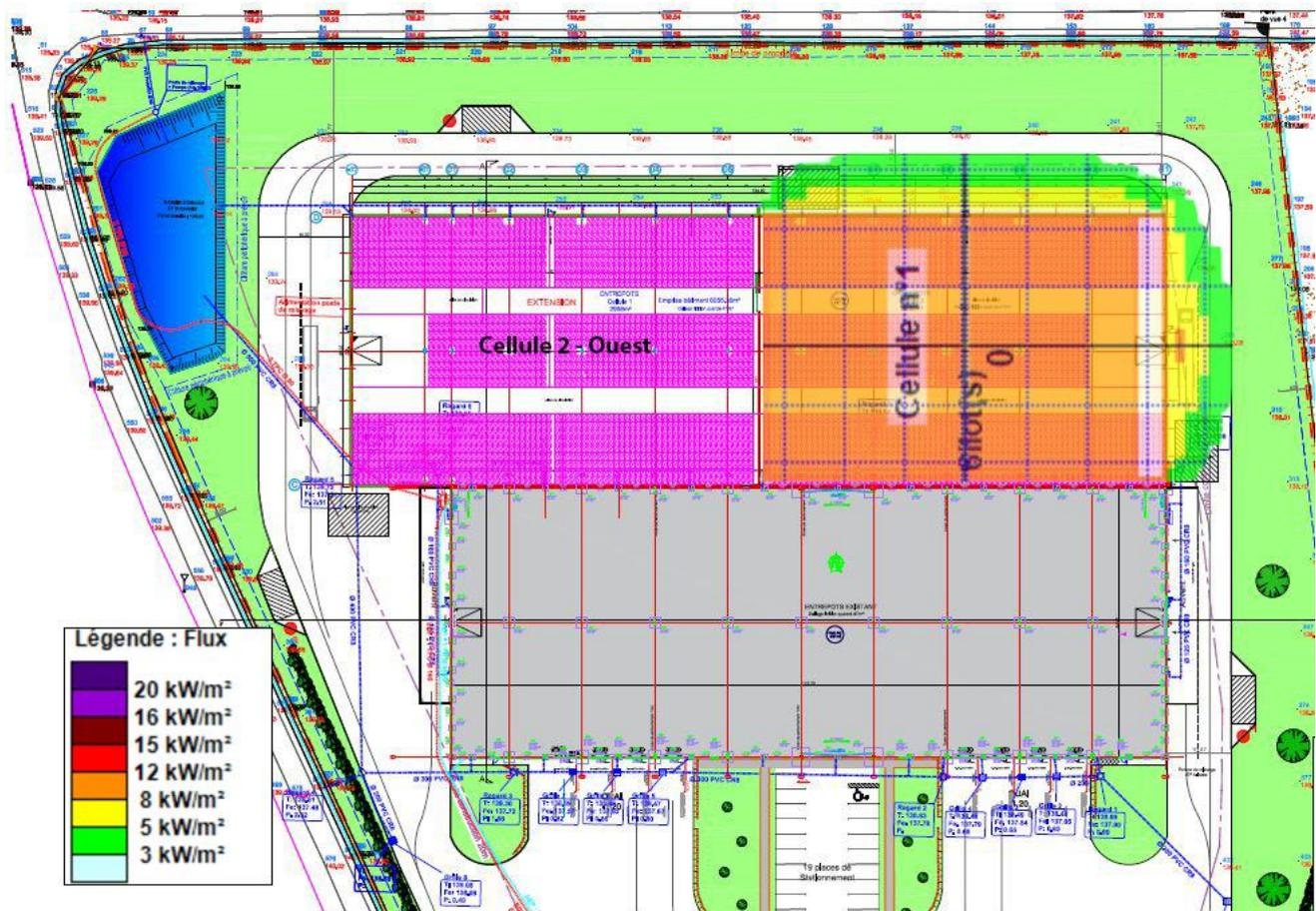
Figure 7 Flux thermiques TH1-2
