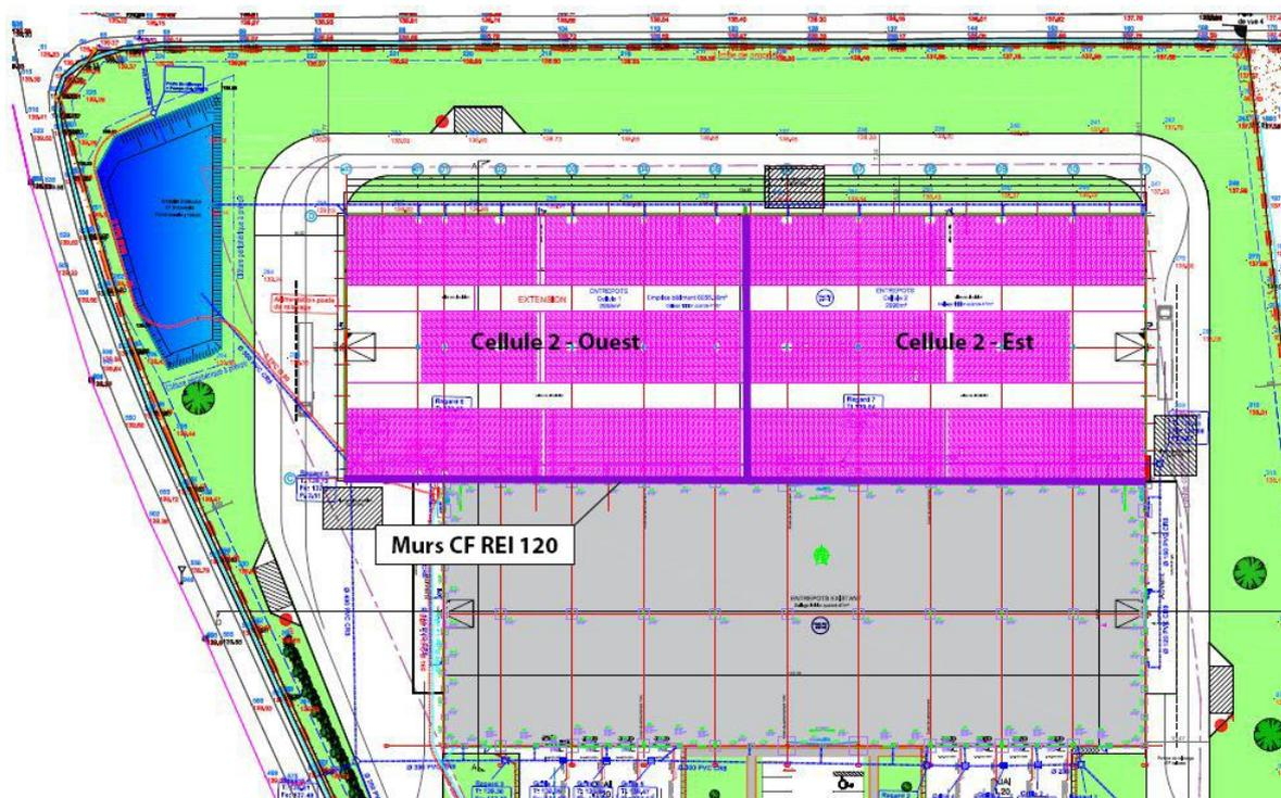
Figure 5 Plan de stockage projeté dans les nouvelles cellules
