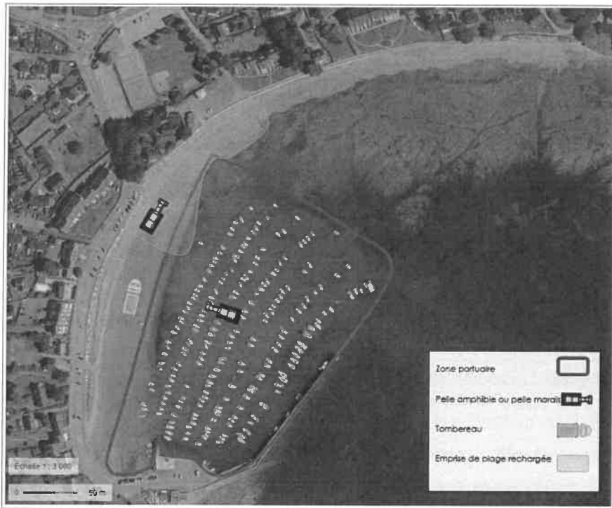
Illustration 4 : Organisation du chantier pour les sédiments de la zone B
