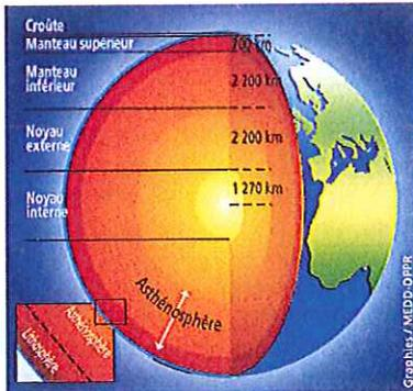
Un séisme est une fracturation brutale des roches en profondeur le long de failles en profondeur dans la croûte terrestre (rarement en surface). Le séisme génère des vibrations importantes du sol qui sont ensuite transmises aux fondations des bâtiments.
